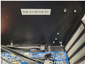
Рисунок 6 – Расположение маркировки на корпусе
